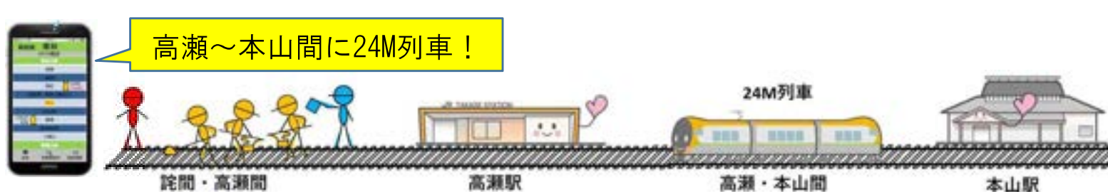
列車見張補助装置の使用イメージ
