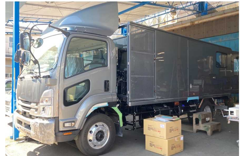
図：製作中の多機能軌陸車
